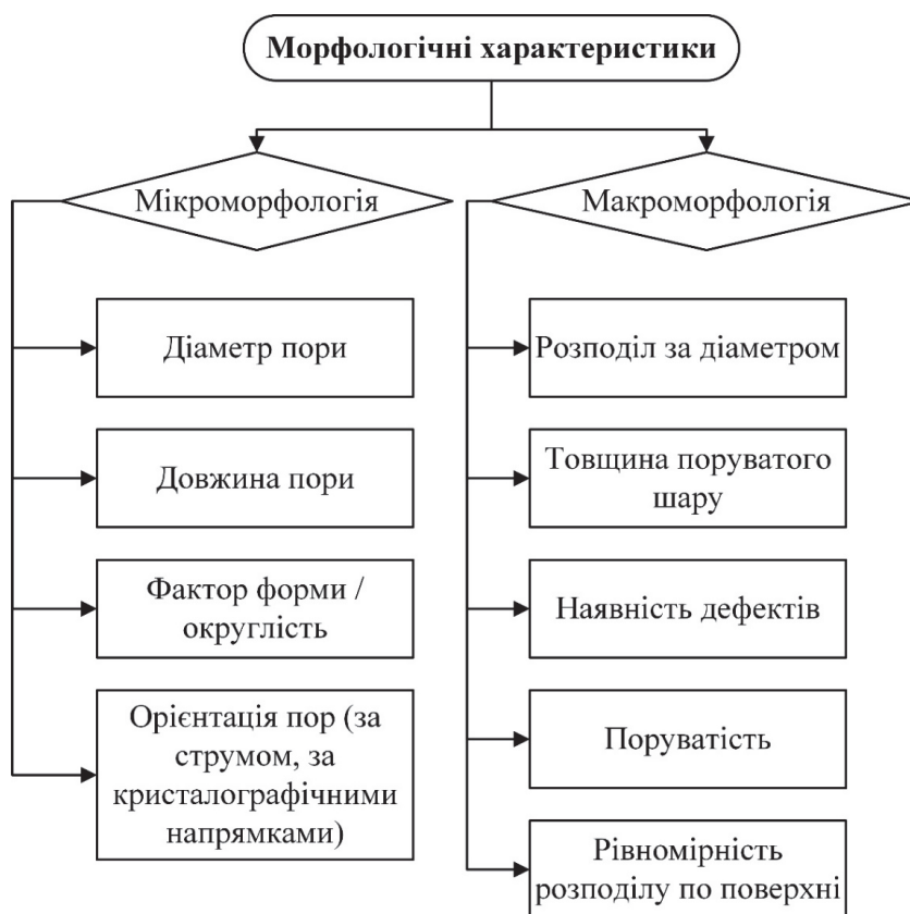
Рисунок 5.4 – Макро- та мікро- морфологічні характеристики наноматеріалу (на прикладі поруватих структур)
