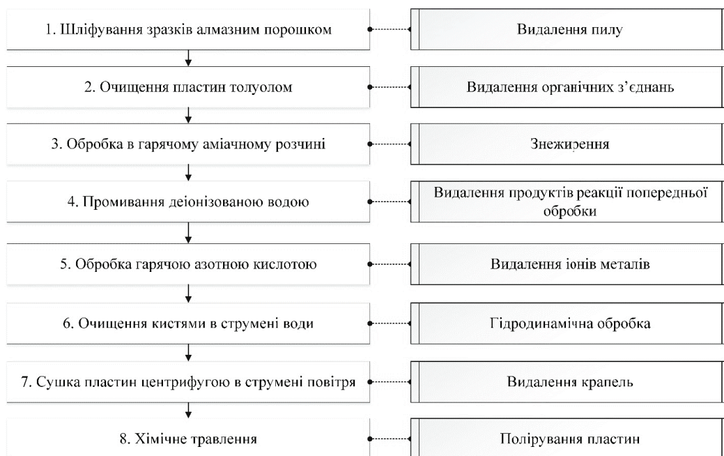
Рисунок 3.3 – Схема очистки напівпровідникових пластин
