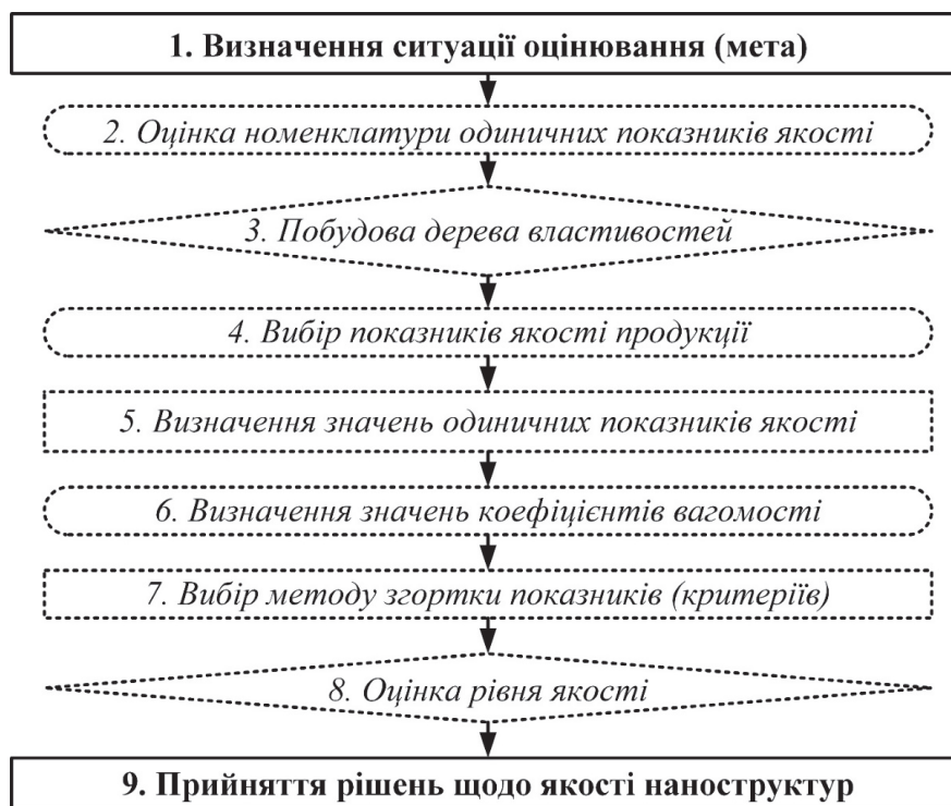
Рисунок 2.10 – Алгоритм визначення рівня якості матеріалу за груповими показниками якості
