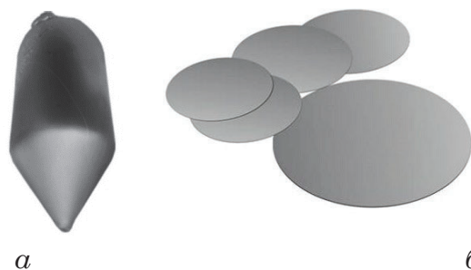
Рисунок 3.2 – Монокристалічний кремній: a – монокристалічні злитки; б – відполіровані пластини
