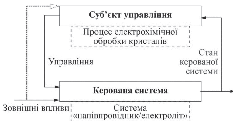
Рисунок 4.3 – Загальна схема системи управління якістю наноструктур
