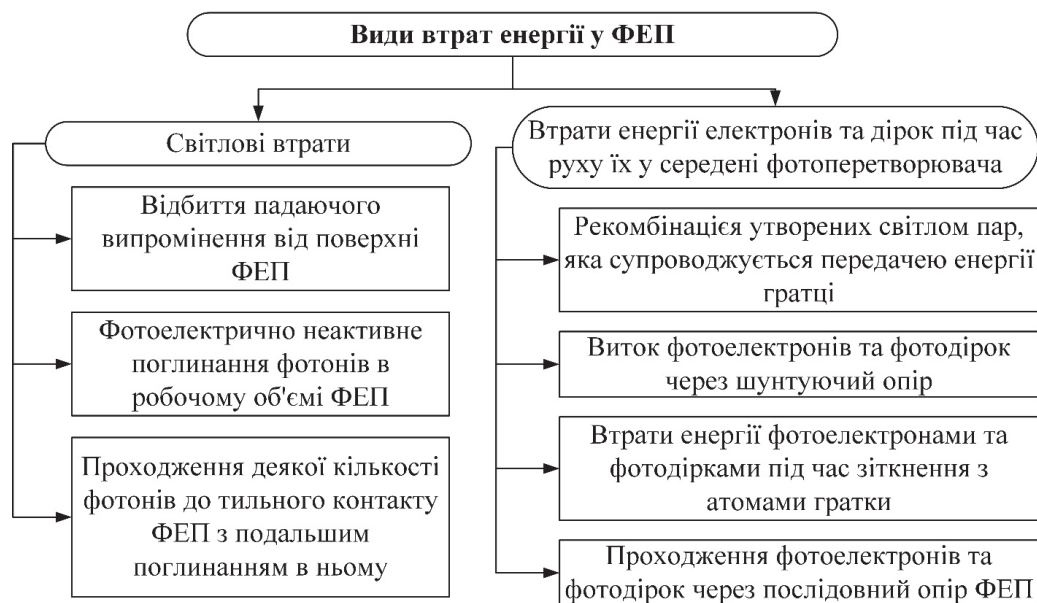
Рисунок 1.12 – Основні види втрат енергії в фотоелектричних перетворювачах
