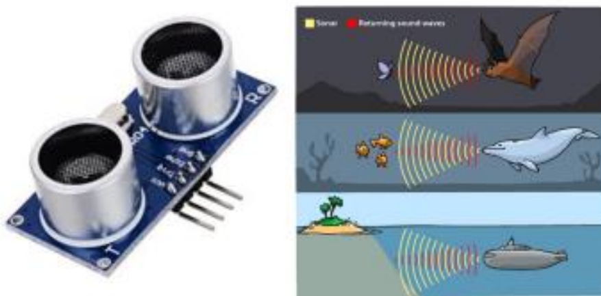
Рис. 2.2. а) Вигляд ультразвукового датчика HC-SR04; б) Приклади застосування ультразвуку
