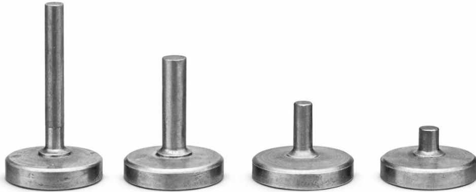
Рис. 1 – Форми горловин труб, які отримують методом ротаційної обкатки
