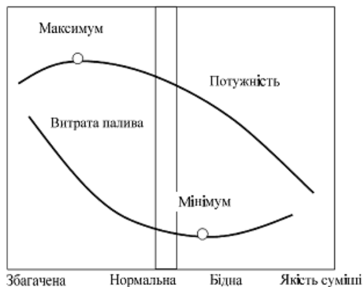
Рис. 3.2 – Залежність потужності та економічності двигуна від якості суміші.
