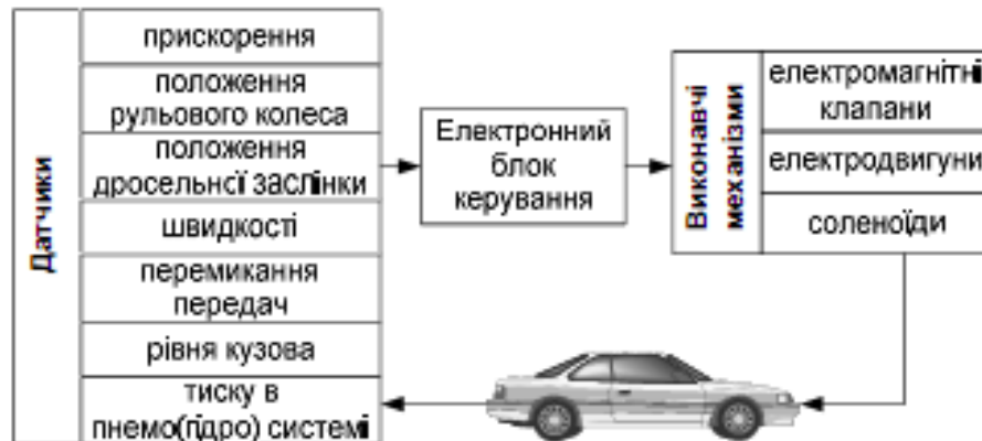
Рис. 5.1 – Структурна схема електронного керування підвіскою.
