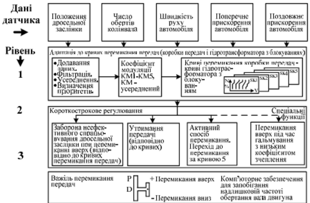
Рис. 4.4 – Діаграма процесу переключення передач Tiptronic.
