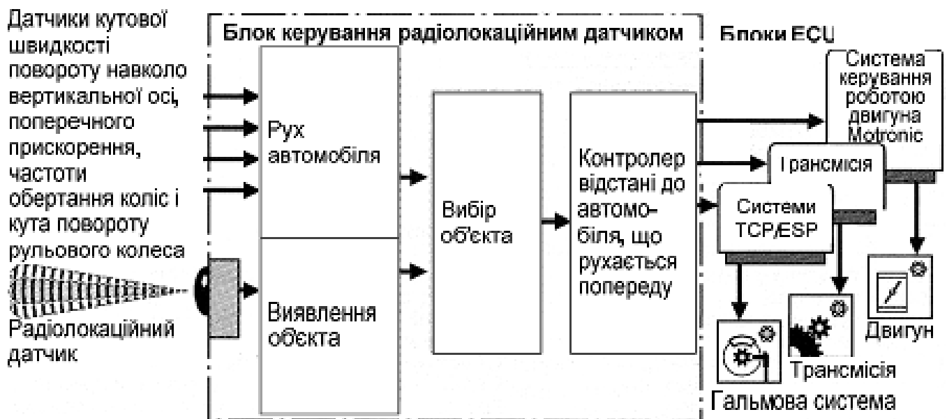
Рис. 6.8 – Основна структура керування системи АСС.
