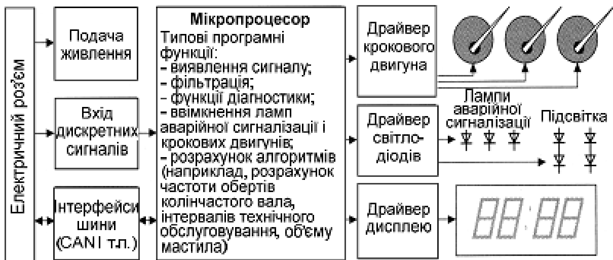
Рис. 7.4 - Блок-схема функціонування комбінації приладів з використанням бортового контролера зв'язку CAN.
